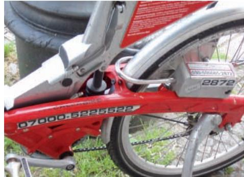
Foto 7. Mecanismo de desbloqueo junto a los códigos y número de teléfono en las bicicletas Call a Bike. Fuente: ConBici.
