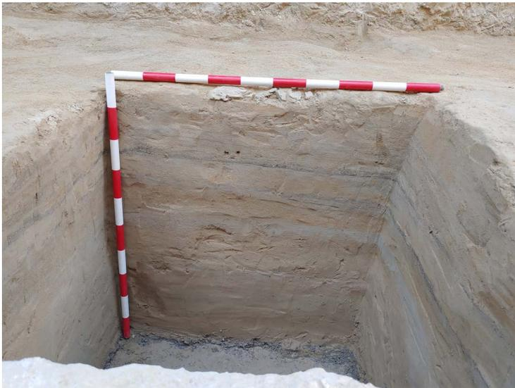
Figura 4. Perfil este de la cata 1100 realizada junto al malecón. Secuencia estratigráfica que muestra los diferentes depósitos formados por las avenidas del río.
